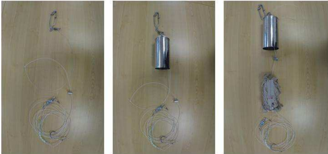
Figure 6 - Fixation du dispositif B à l'avançon : attache du carré de déclenchement (g.), fixation de la partie fixe au snap (centre), passage de l'avançon dans la partie mobile (d.)
