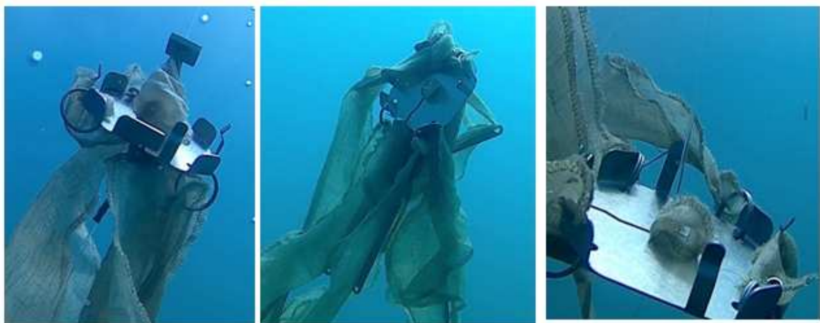
Figure 16 - Blocage d'une voile au centre du support métallique
