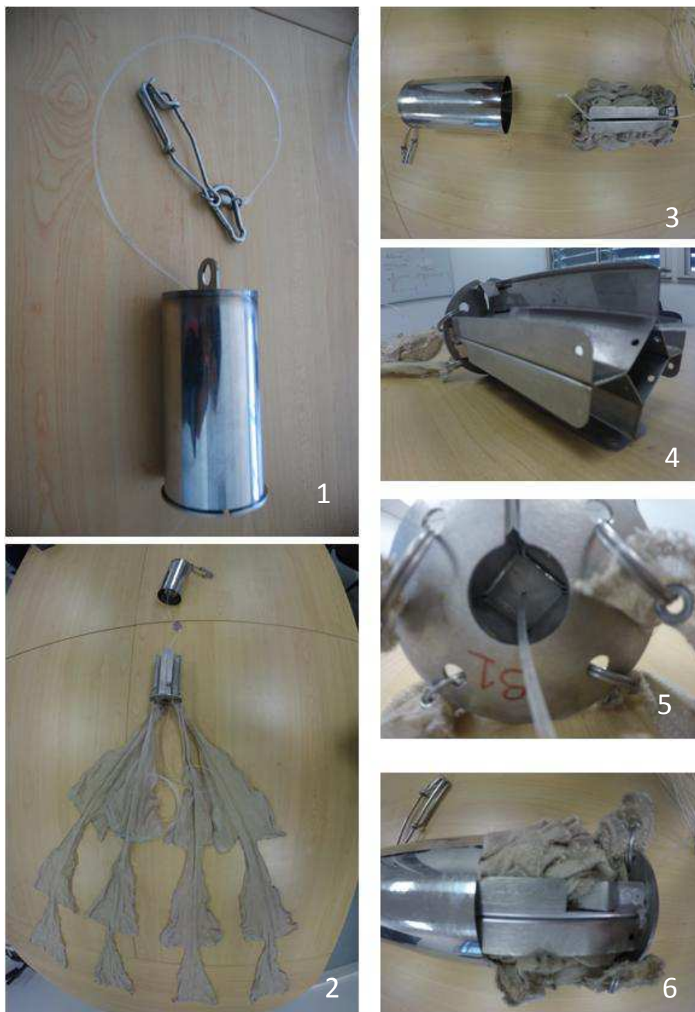
Figure 5 - Dispositif B au repos (1), dispositif déployé (2), système de passage de l'avçon (3), espace de rangement des voiles (4), système de déclenchement au repos (5), système de déclenchement en action (6)
