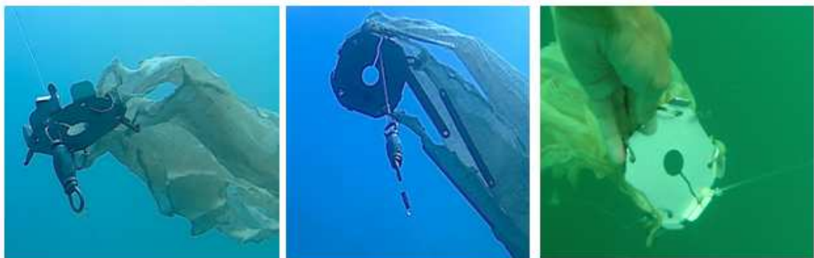
Figure 15 - Blocage de l'avançon dans l'ouverture du support métallique
